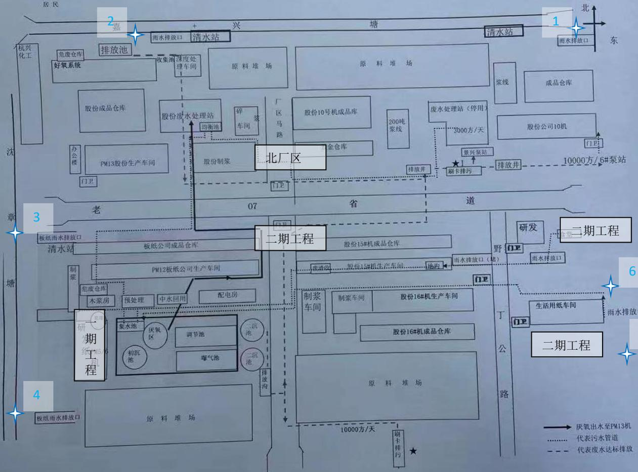
附图 7 雨水管网、雨水排放口位置示意图 ✨
